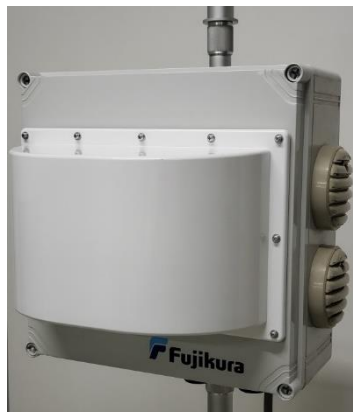
図 5 60 GHz 帯広帯域通信モジュールを搭載した筐体
